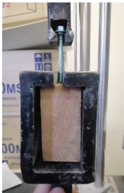
รูปสกรู STL1 73 ยึดเข้ากับแป้นไม้ยางความลึก 20 มม.
