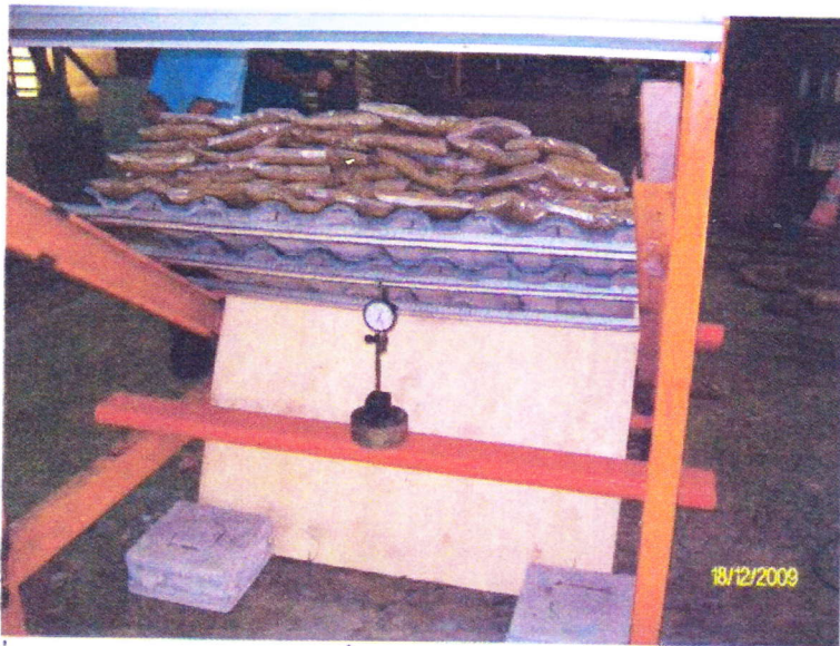
รูปที่ 9 แสดงการแฉ่นตัวของแปที่ความลาดชัน 30^\circ เมื่อรับน้ำหนักที่ 335 \text{ กก/ม}^2
