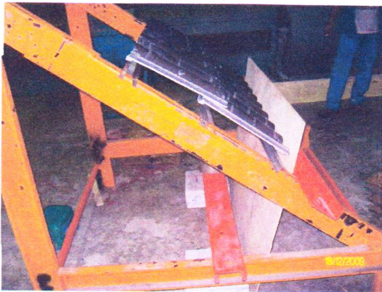
รูปที่ 5 แสดงโครงหลังคาจำลองที่ความลาดชัน 37^\circ เพื่อใช้ในการทดสอบรับน้ำหนัก บรรทุกของแป
