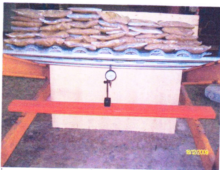
รูปที่ 8 แสดงการแอ่นตัวของแป้ที่ความลาดชัน 20° เมื่อรับน้ำหนักที่ 335 กก/ม 2
