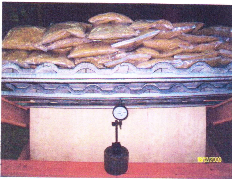
รูปที่ 10 แสดงการแฉ่นตัวของแปที่ความลาดชัน 37^\circ เมื่อรับน้ำหนักที่ 335 \text{ กก/ม}^2
