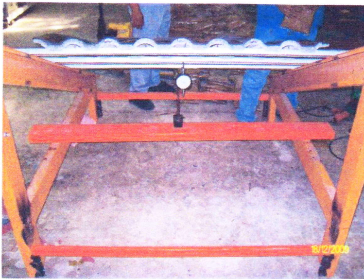
รูปที่ 6 แสดงจุดติดตั้ง Dial Gauge เพื่อวัดค่า Deflection ของแปที่จุดกึ่งกลางแป
