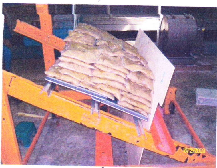
รูปที่ 7 แสดงการทดสอบความสามารถรับน้ำหนักที่จุดประลัยด้วยน้ำหนักถุงทราย 280 กก. คิดเป็น 335 กก/ม 2
