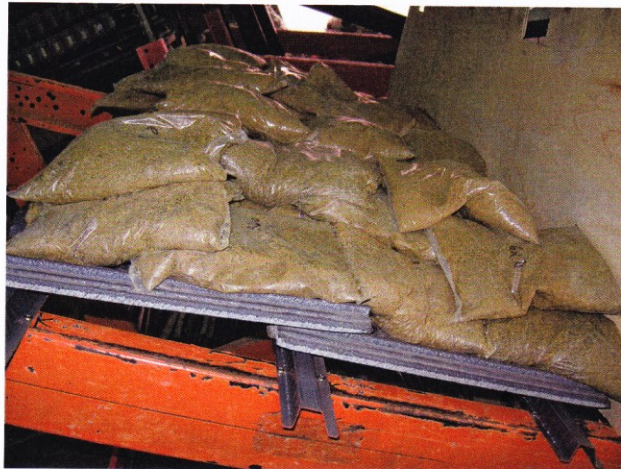
รูปที่ 8 แสดงการทดสอบความสามารถรับน้ำหนักที่จุดประลัยด้วยน้ำหนักถุงทราย 60 กก. คิดเป็น 166 \text{ กก/ม}^2 ที่ความลาดชัน 37^\circ
