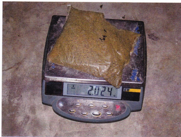
รูปที่ 6 แสดงภาพถุงทรายที่ใช้ทดสอบ น้ำหนักประมาณถุงละ 2 กิโลกรัม
