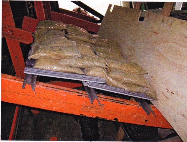
รูปที่ 7 แสดงการทดสอบความสามารถรับน้ำหนักที่จุดประลัยด้วยน้ำหนักถุงทราย 55 กก. คิดเป็น 134 \text{ กก/ม}^2 ที่ความลาดชัน 25^\circ
