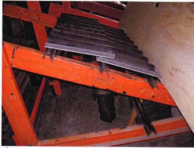
รูปที่ 3 แสดงโครงหลังคาจำลองที่ความลาดชัน 25^\circ เพื่อใช้ในการทดสอบรับน้ำหนักบรรทุกของแป
