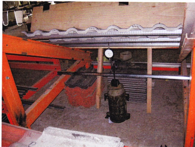
รูปที่ 4 แสดงจุดติดตั้ง Dial Gauge เพื่อวัดค่า Deflection ของแปที่จุดกึ่งกลางแป
