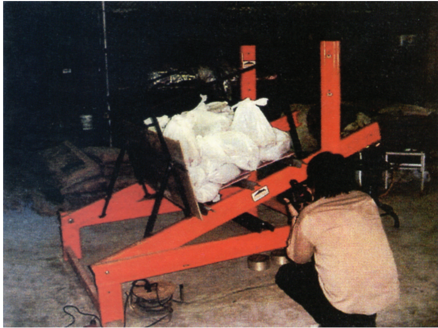
รูปที่ 7 : แสดงการทดสอบความสามารถรับน้ำหนักแปสำหรับความลาดชัน 17^\circ
