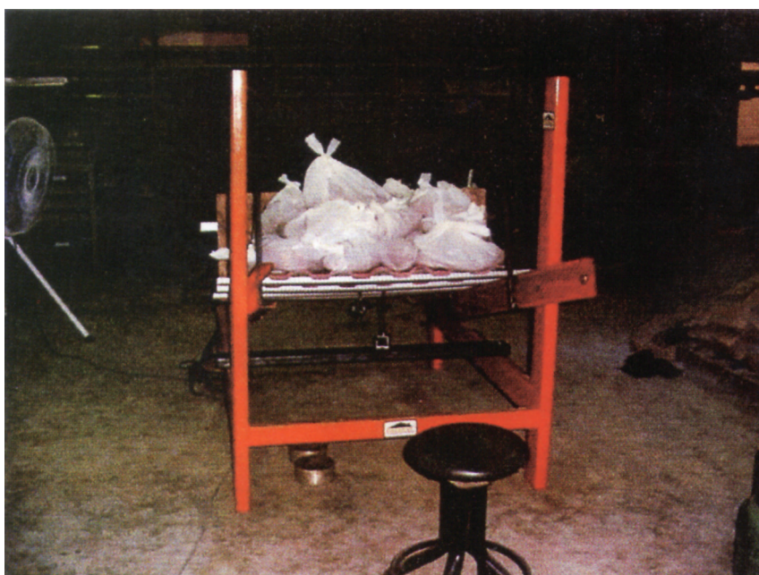
รูปที่ 9 : แสดงการทดสอบความสามารถในการรับน้ำหนักบรรทุกใช้งานของแปสำหรับความลาดชัน 17^\circ
