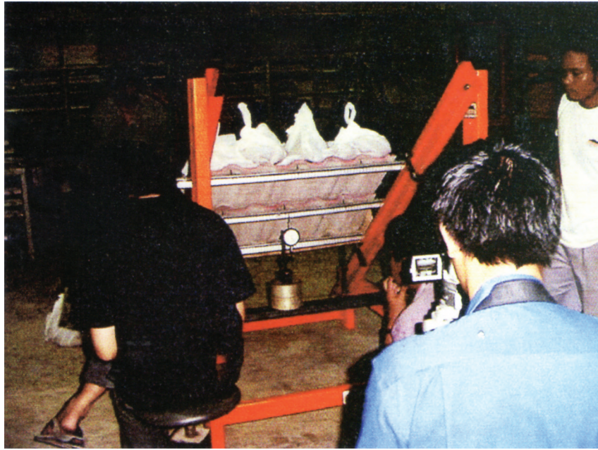
รูปที่ 15 : แสดงการวัดการแอ่นตัวของแปสำหรับความลาดชัน 40^\circ ในรูปมีน้ำหนักกระทำเท่ากับ 222 \text{ กก/ม}^2
