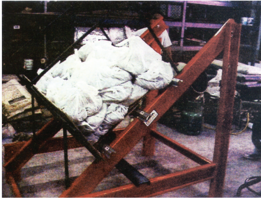
รูปที่ 13 : แสดงการวัดการแน่นตัวของแปสำหรับความลาดชัน 40^\circ
