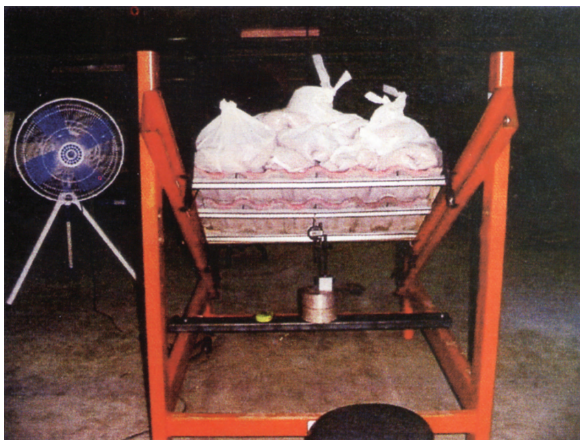
รูปที่ 11 : แสดงการวัดการแอ่นตัวของแปสำหรับความลาดชัน 30^\circ
