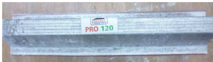
Pic 5 : แป้ Profast 0.48 AZ ทดสอบละอองเกลือ 550 Hrs.
