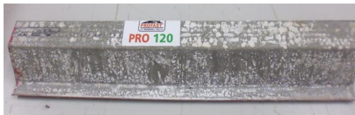
Pic 4 : แป้ Profast 0.48 AZ ทดสอบไอกรด 6-7 Cycles
